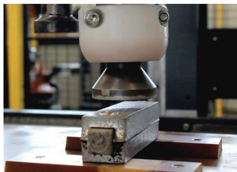
*Entkernprüfkörper ©Fraunhofer IGCV*
